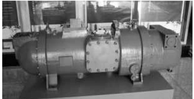
Φ200mm 螺杆的水源热泵单螺杆制冷压缩机
