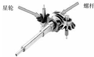
图2 单螺杆热泵压缩机的关键部件
