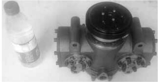
Φ90mm 螺杆的汽车热泵单螺杆制冷压缩机样机
