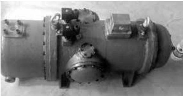
Φ117mm 螺杆空气源热泵单螺杆制冷压缩机
