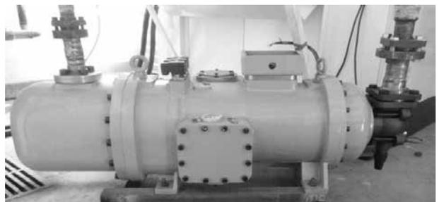
图 9 第二代单螺杆制冷压缩机样机
