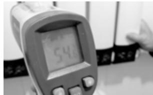
图 16 暖气片表面温度 54.7℃
