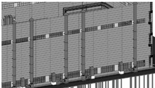
图5 机械排风室外风管高空排放
