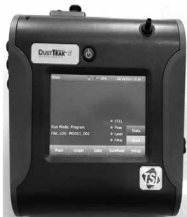
图 1 细颗粒物质量浓度测量仪
