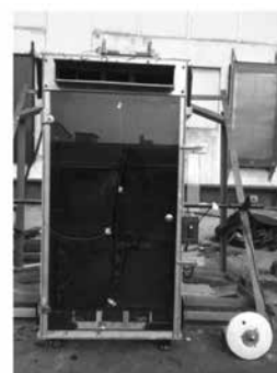
图3(b) 太阳能热催化空气净化采暖墙本体照片
