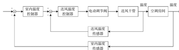
图 2 CAV 系统控制方框图
