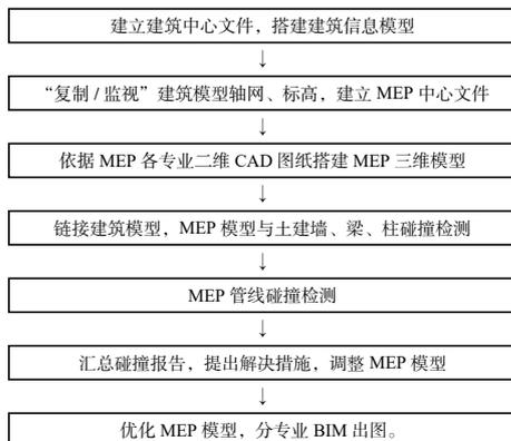
图 4 基于 BIM 技术的协同设计工作流程
