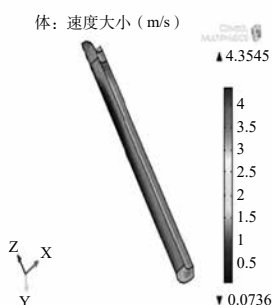
图9 风速为0.5m/s时进风管内速度分布图
