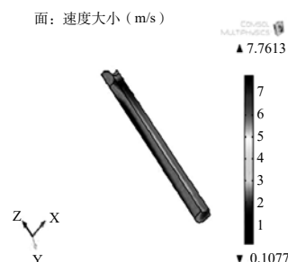
图12 风速为2.5m/s时进风管内速度分布图
