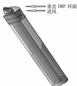
图7 半圆环进风管道
