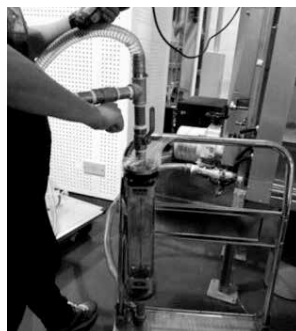
图 1 恒压法现场测试照片 图 2 压力衰减法现场测试照片 按式(1)计算房间围护结构的小时空气泄漏率 [3] :
