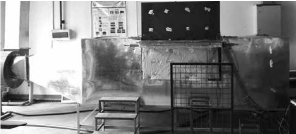
图 6 装有布好试件测点的试验台架
