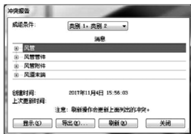
图 15 Revit 中碰撞检查
