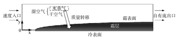
图 9 冷表面结霜模拟计算域
