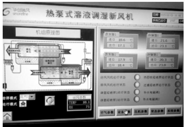
图9 热泵式溶液调湿新风机组
