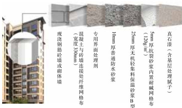
图2 建筑外墙组成
