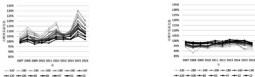
图 15 2005 年围护结构模型（模型 A）尖峰冷热负荷模拟结果
