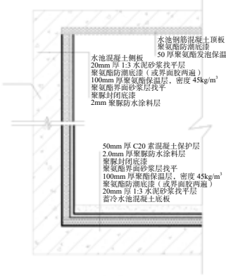
图 6 消防兼冷水池结构示意图
