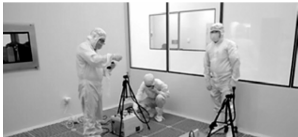
图 5 核心区洁净度测试
