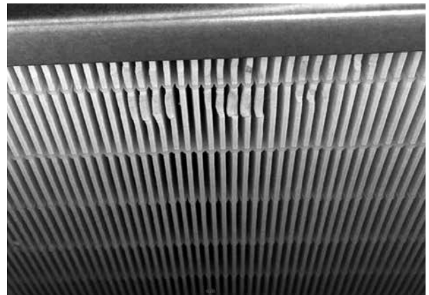
图5 高效过滤器滤芯破损
